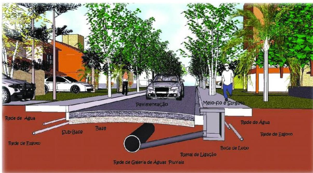
FIGURA 603 – CROQUI ESQUEMÁTICO DOS DISPOSITIVOS DE MICRODRENAGEM PLUVIAL
