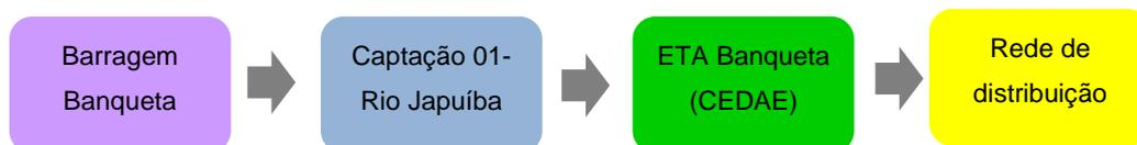
FIGURA 198 – FLUXOGRAMA DO SISTEMA DE ABASTECIMENTO DE ÁGUA JAPUÍBA – SUBSISTEMA BANQUETA (CEDAE)
