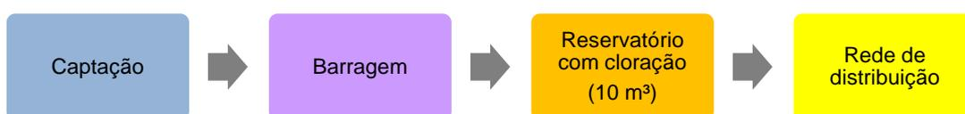
FIGURA 378 – FLUXOGRAMA DO SISTEMA DE ABASTECIMENTO DE ÁGUA CUSSABÁ
