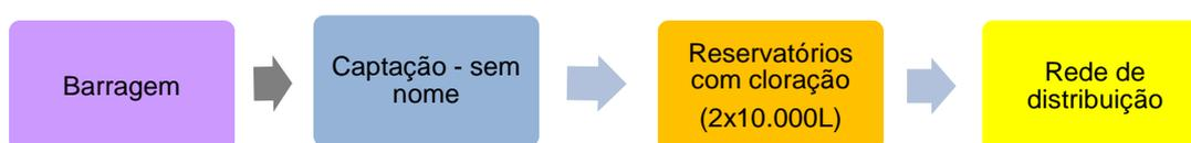
FIGURA 156 – FLUXOGRAMA DO SISTEMA DE ABASTECIMENTO DE ÁGUA GRANDE JAPUÍBA – SUBSISTEMA PARQUE BELÉM
