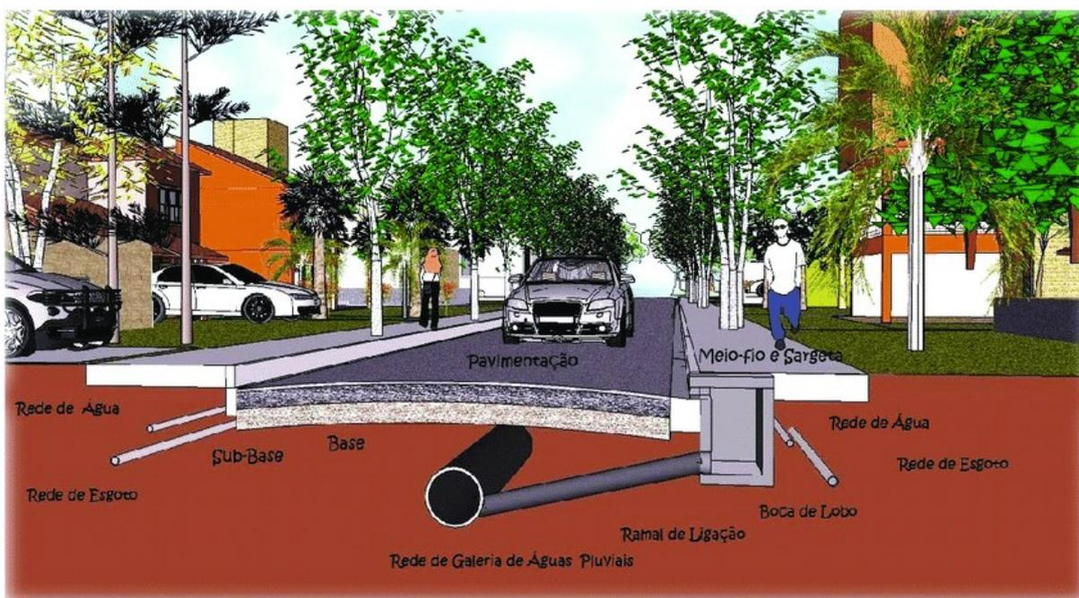
FIGURA 7-1 – CROQUI ESQUEMÁTICO DOS DISPOSITIVOS DE MICRODRENAGEM PLUVIAL
