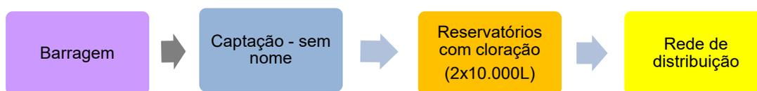
FIGURA 5-51 – FLUXOGRAMA DO SISTEMA DE ABASTECIMENTO DE ÁGUA GRANDE JAPUÍBA – SUBSISTEMA PARQUE BELÉM
