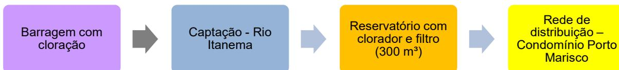
FIGURA 5-160 – FLUXOGRAMA DO SISTEMA DE ABASTECIMENTO DE ÁGUA DO CONDOMÍNIO PORTO MARISCO
